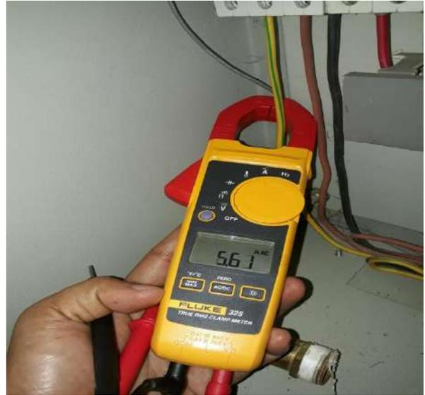
Gambar 4.2 Pengukuran Beban 2 Motor
