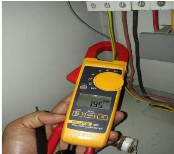
Gambar 4.2 Pengukuran Beban 1 Motor
