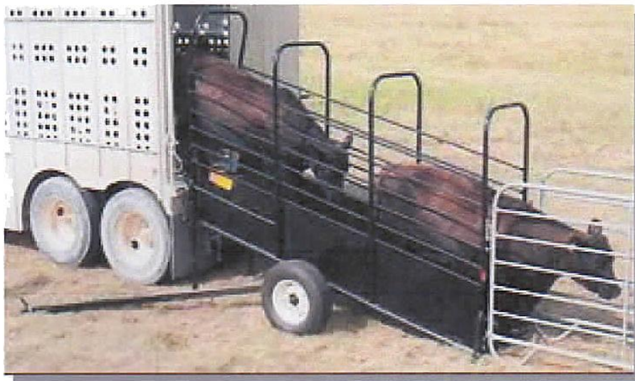
Gambar 7 : Sistem loading ternak dengan konstruksi ideal
